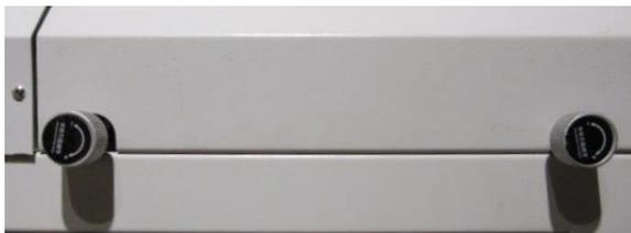
Таким образом стол обработки переплета может быть выставлен в горизонтальной плоскости с базовым столом, но быть выше или ниже (любое угловое смещение недопустимо).
