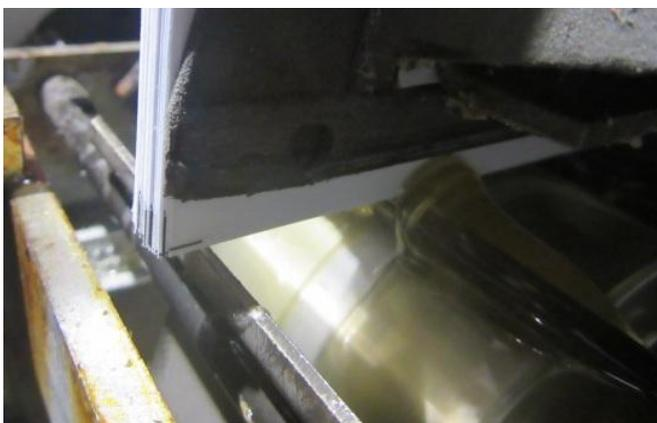
Следует учитывать, что регулировка общего уровня ванны соответствующим винтом приподнимает или опускает ванну в большей степени в части боковой проклейки и значительно меньше влияет на степень погружения корешка в поднятую на горизонтальном валике волну клея.
