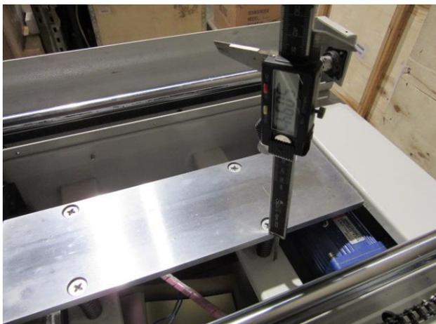
Проверяем положение стола относительно перекладин шасси штангенциркулем в 4-х узловых точках.
