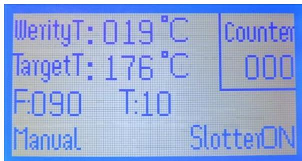
Дисплей отображает реальную температуру нагрева клеевой ванны – **Werity T**, заданную температуру – **Target T**, оперативный счетчик продукции – **Counter**, установленные силу обжима «F» и время обжима «T» переплета, а также режим работы – ручной или автоматический, **Slotter ON / OFF** – (вкл/выкл) фрезы и дежурный режим **Keep warm**.
