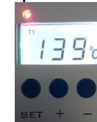
Для задания температуры необходимо нажать кнопку «SET» для переключения значения в верхней части дисплея с параметра «T1» (температура в реальном времени) на параметр «T2» (задаваемая температура), после чего выставляем нужную температуру используя кнопки «+» и «-» после чего снова нажмите кнопку «SET»
