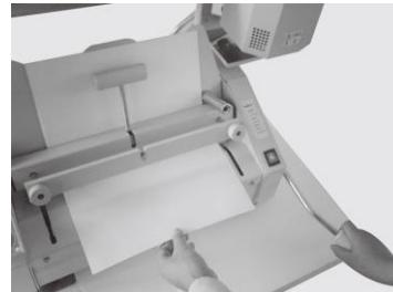
**10. Извлечь скрепленный блок из аппарата: а) отжать пресс-зажим; б) извлечь скрепленный блок. Блок можно извлекать сразу после операции обжима, не дожидаясь окончательного застывания клея.**
